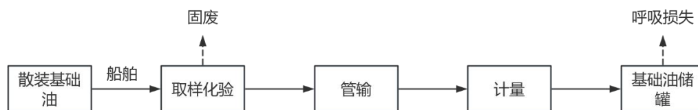
图8 营运期散装基础油入库工艺流程及产污节点
