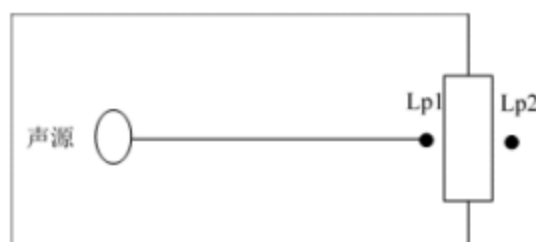
图 4-2 室内声源等效为室外声源例图
