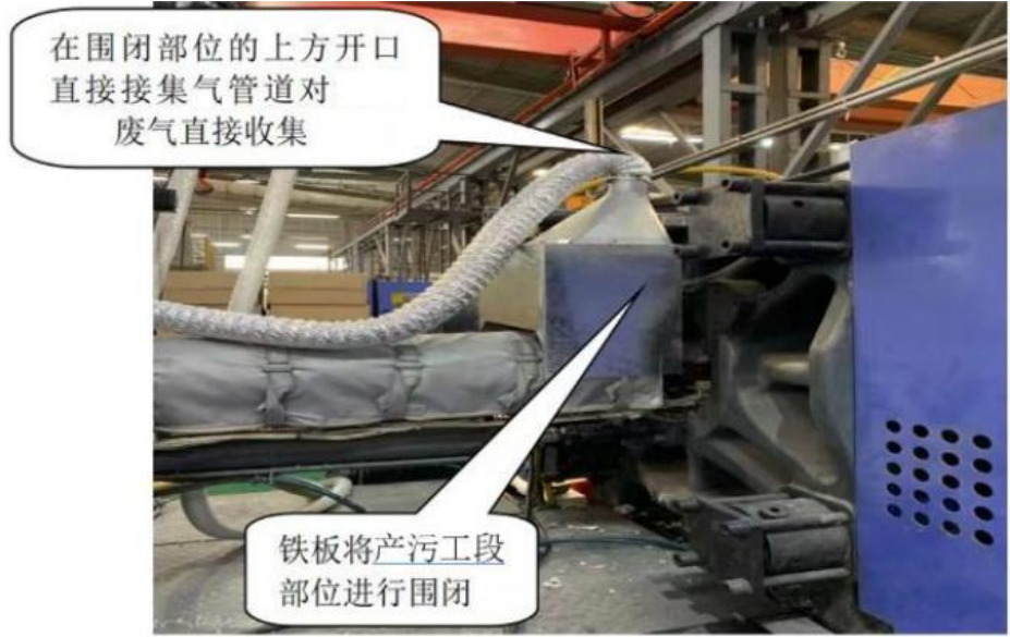
图 4-1 包围型集气设备（顶部集气罩+三面围挡）示意图
