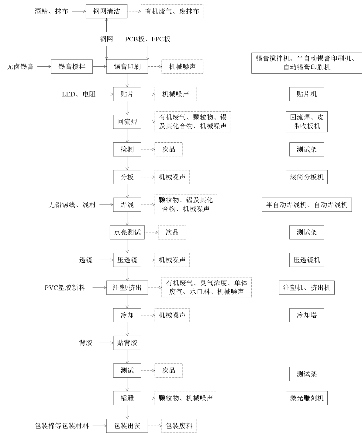
图 2-4 本项目注塑/挤出工艺的 LED 灯条生产工艺流程及产污环节
